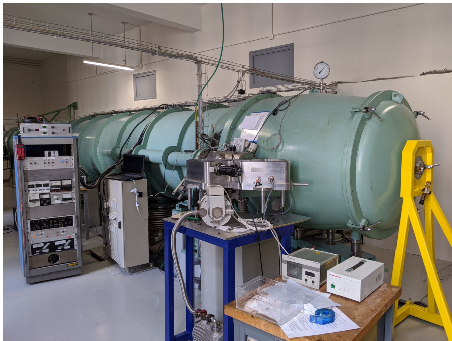
FIGURE I.6 – Spectrographe de 10.7 m UV sous vide de l'Observatoire de Paris-Meudon.
