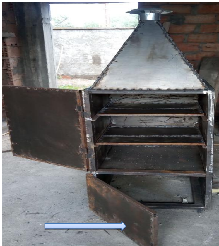
Figure IV.2: chambre de combustion
