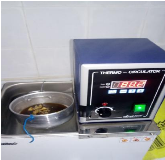
Figure IV.15: chauffage du MCP au bain marie Trois composants
