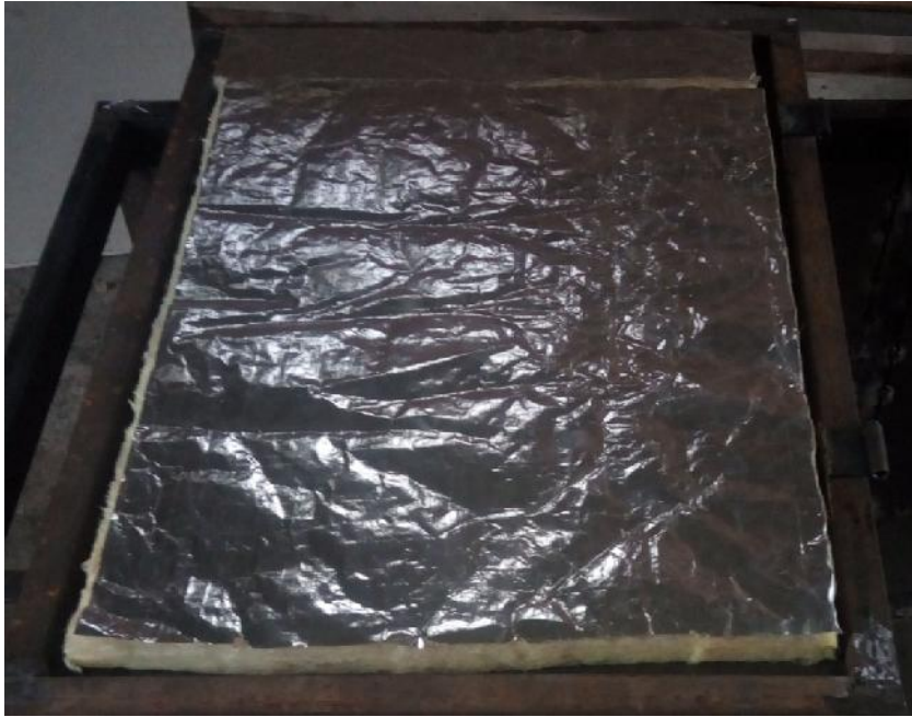
Figure IV.2: isolation pour la porte de la chambre de combustion
