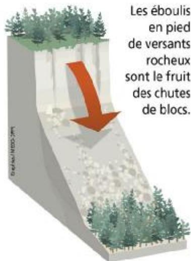
**Figure (I-4):** Liaison entre les éboulements et les chutes de blocs
