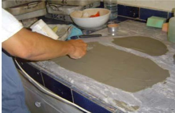
Figure (II-10) : Homogénéisation de la prise d'essai.
