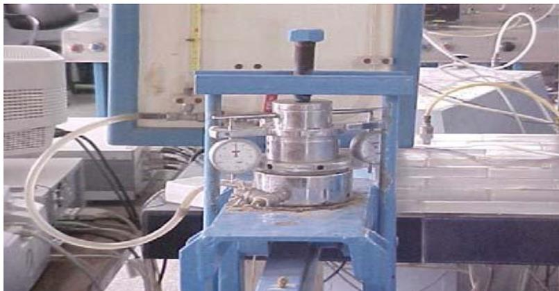
Figure (II-18) : Dispositif oedométrique.
