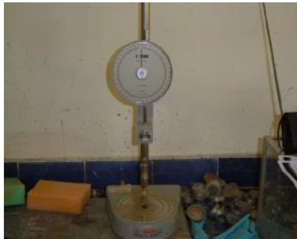
**Figure (II-12):** Pénétromètre à cône.
