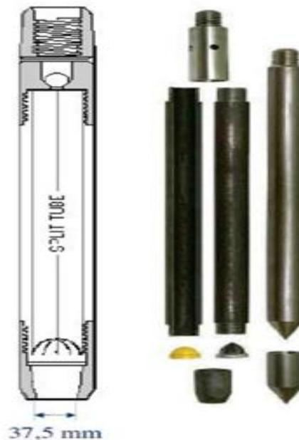
**Figure (II-8) :** Le dispositif général d'un pénétromètre standard (Carottier fendu).
