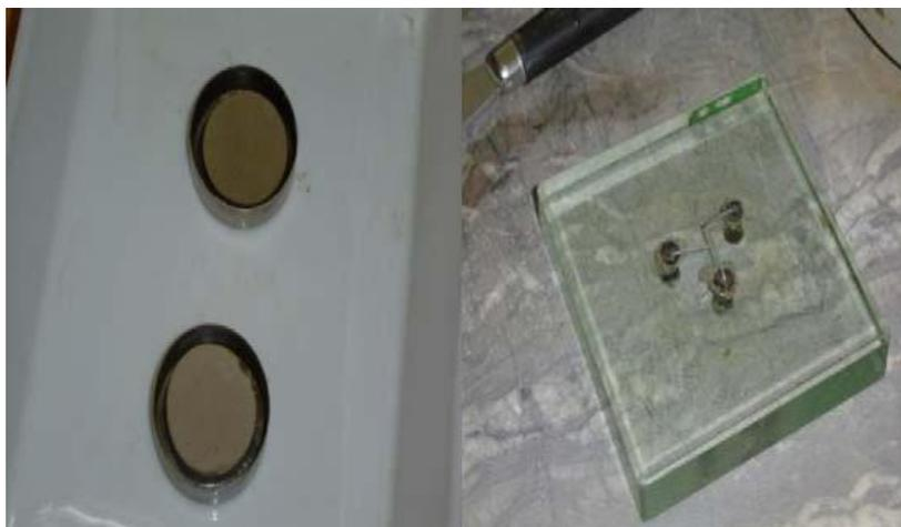
**Figure (II-14):** Appareillage pour la limite de retrait (les capsules après dessiccation à gauche ; la plaque avec pointes à droite)
