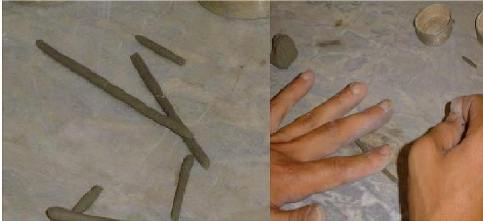
**Figure (II-13):** Confection des rouleaux pour la limite de plasticité
