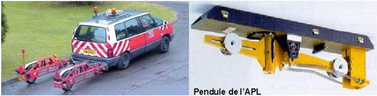
**Fig. V.7 : Analyseur de Profil en Long (APL),[LCPC-SETRA 2007]**
