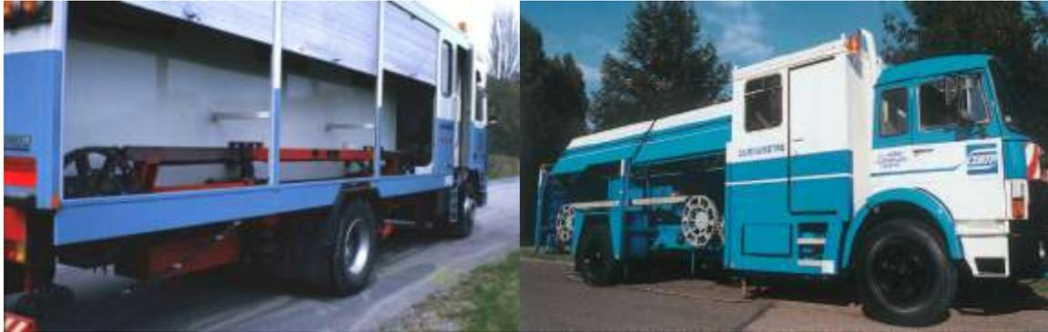
Fig. V. 23 : Le Curviamètre [LCPC-2007]
