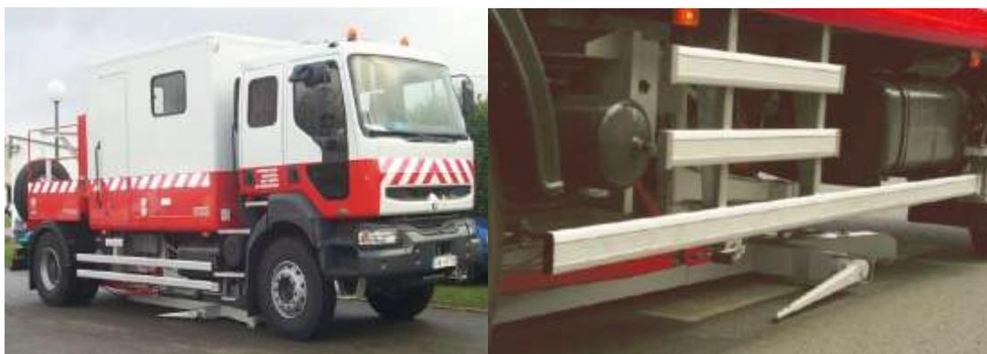
**Fig. V. 21 : Le défectographe [LCPC-VECTRA-CETE]**
