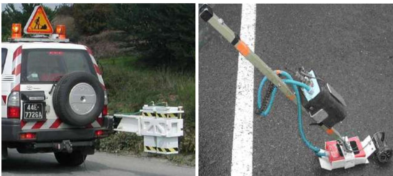
**Fig. V.25 : Radar pour mesures longitudinales et transversales [CETE]**
