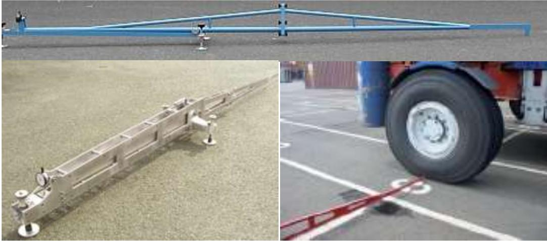
**Fig. V.17 : La poutre Benkelman[LCPC-2007]**
