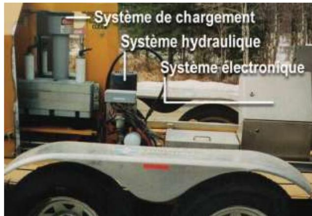
**Fig. V.19 : Vue des trois systèmes principaux du déflectomètre[LCPC-2007]**
