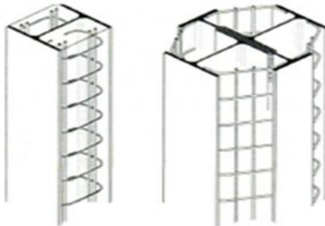
**Figure (a.1) : poteaux partiellement enrobés de béton**
