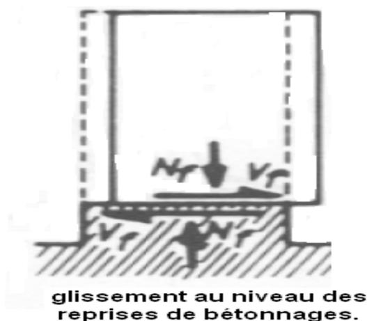
Fig : II.13 : mode E5 de rupture.
