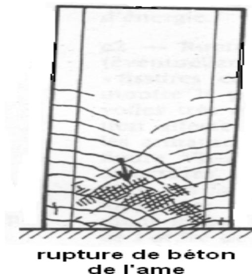
Fig : II.12 : mode E4 de rupture.
