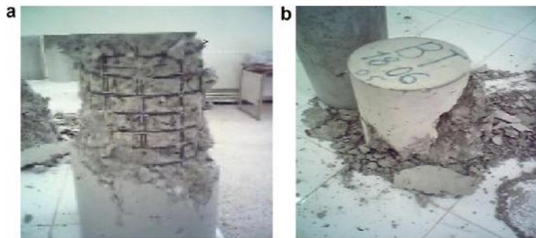
Figure II.25: Mode de rupture des spécimens, (a) béton confiné et (b) béton non confiné.
