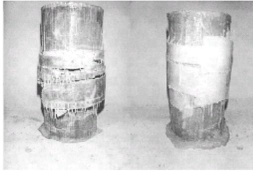
**Figure II.9:** Mode de rupture des cylindres enveloppés avec fibres de verre
