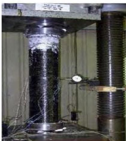
**Figure II.16:** L'installation expérimentale de colonne confinée par CFRP avec une charge concentrique (Hadi, 2006) [23].
