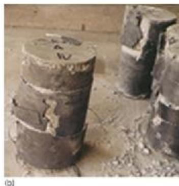
**Figure II.7:** (a) instrumentation; (b) mode de rupture des spécimens de béton enveloppés par des fibres de carbone [19].
