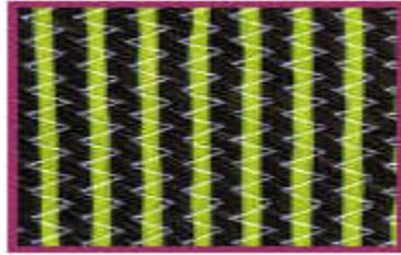
**Figure: III-8 : tissu hybride carbone - aramide. Glossaire matériaux composites, [8]**
