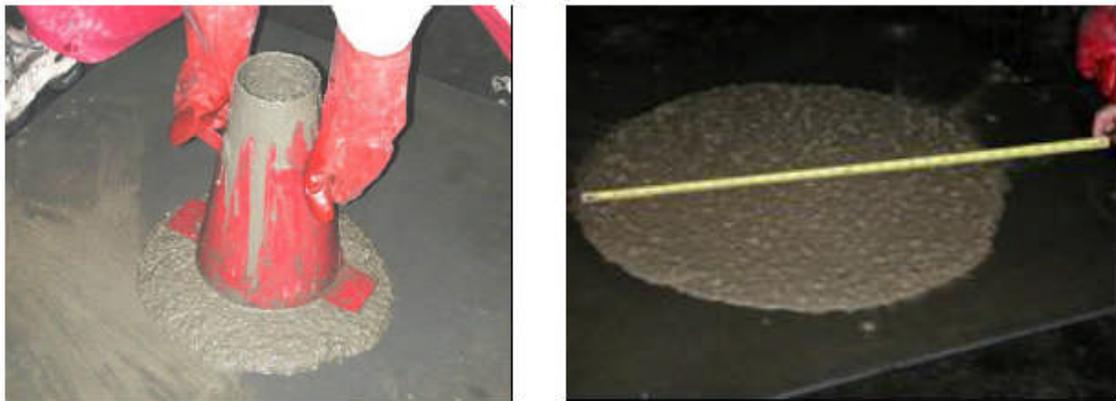
**Figure II-2 : Essai sur étalement du béton autoplaçant****➤ Caractéristiques du béton durci :**
