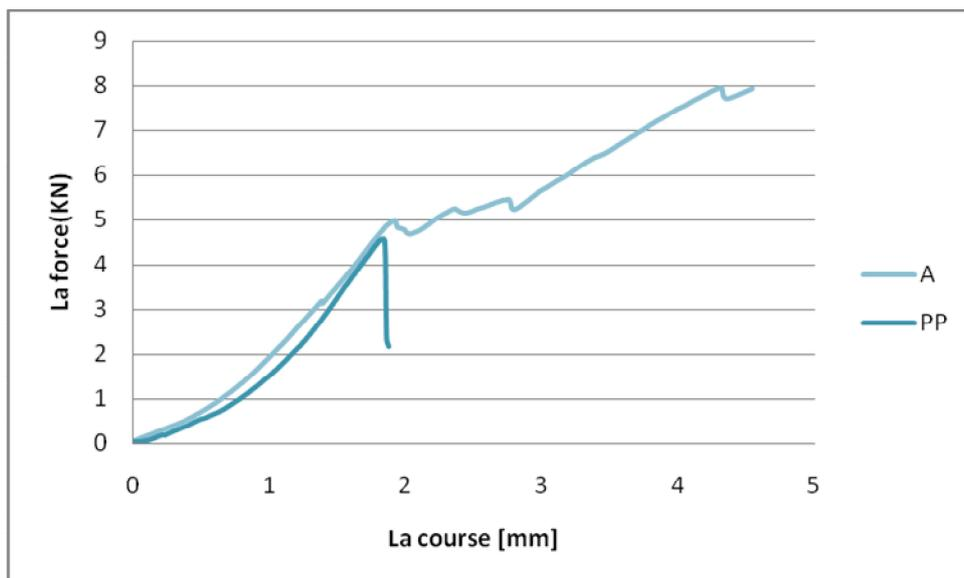
Figure IV-16 : Comparaison avec béton armé et béton polypropylène
