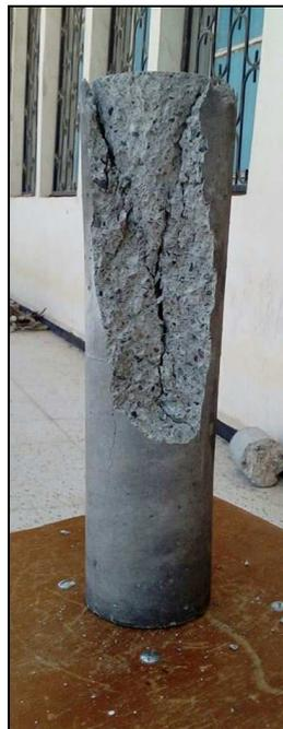
**Figure 4.8 :** Ecrasement de l'éprouvette en béton témoin.
