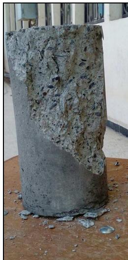
**Figure 4.1 :** *Ecrasement de l'éprouvette en béton témoin.*
