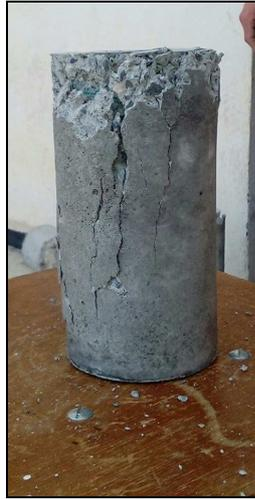
Figure 4.2 : Rupture de l'éprouvette confinée par la grille.
