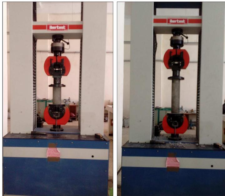
**Figure 3.11 :** Mise en place des éprouvettes.
