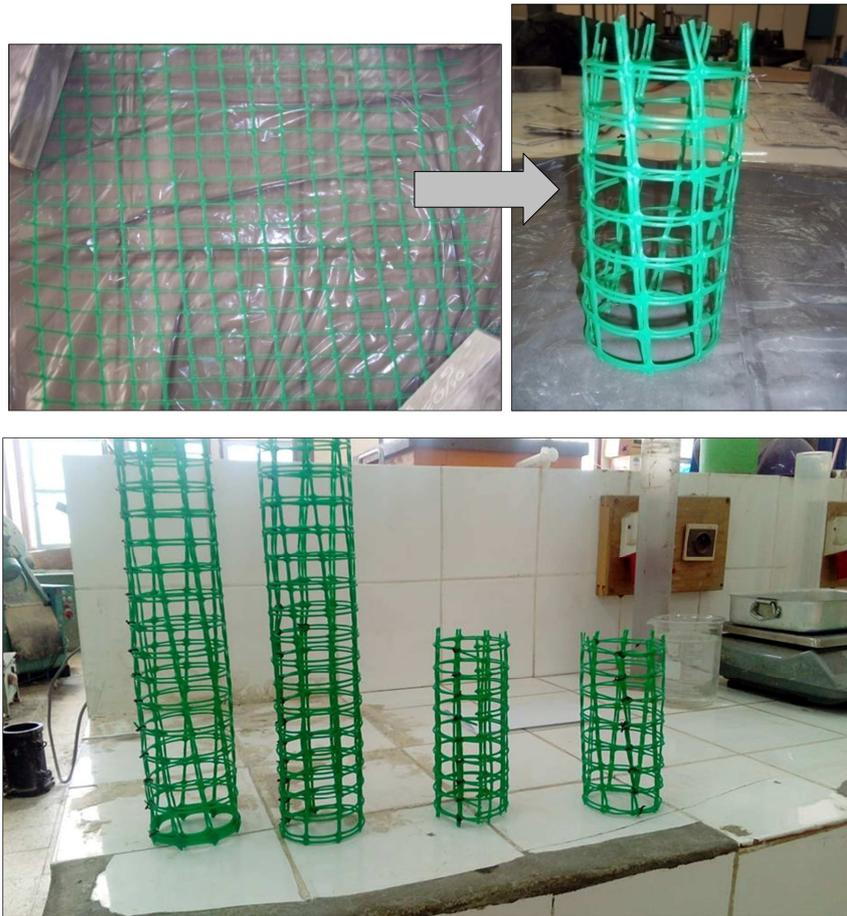
**Figure 3.8 :** Photographie de la préparation de la grille de renfort.
