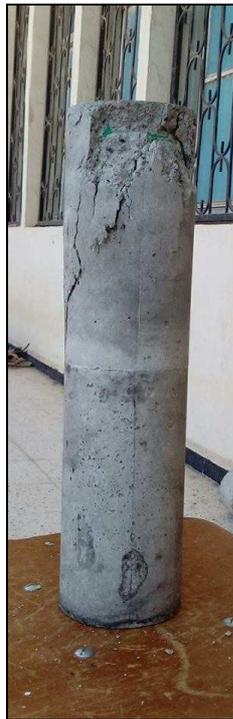
**Figure 4.9 :** Rupture de l'éprouvette confinée par la grille.
