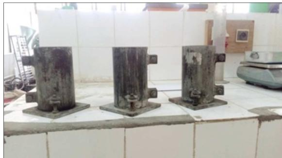
**Figure 3.1:** d'éprouvettes de dimensions 10×20.
