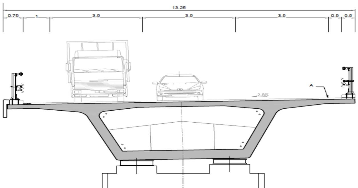
Figure I-7 : profil en travers du projet
