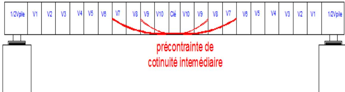
FigureV.11 : Tracé des câbles sur l travée intermédiaire
