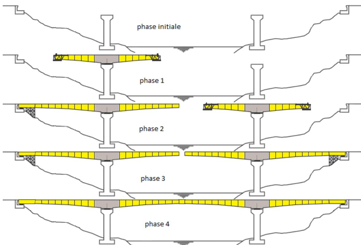
Figure IV.1 : différentes phases de la construction du fléau
