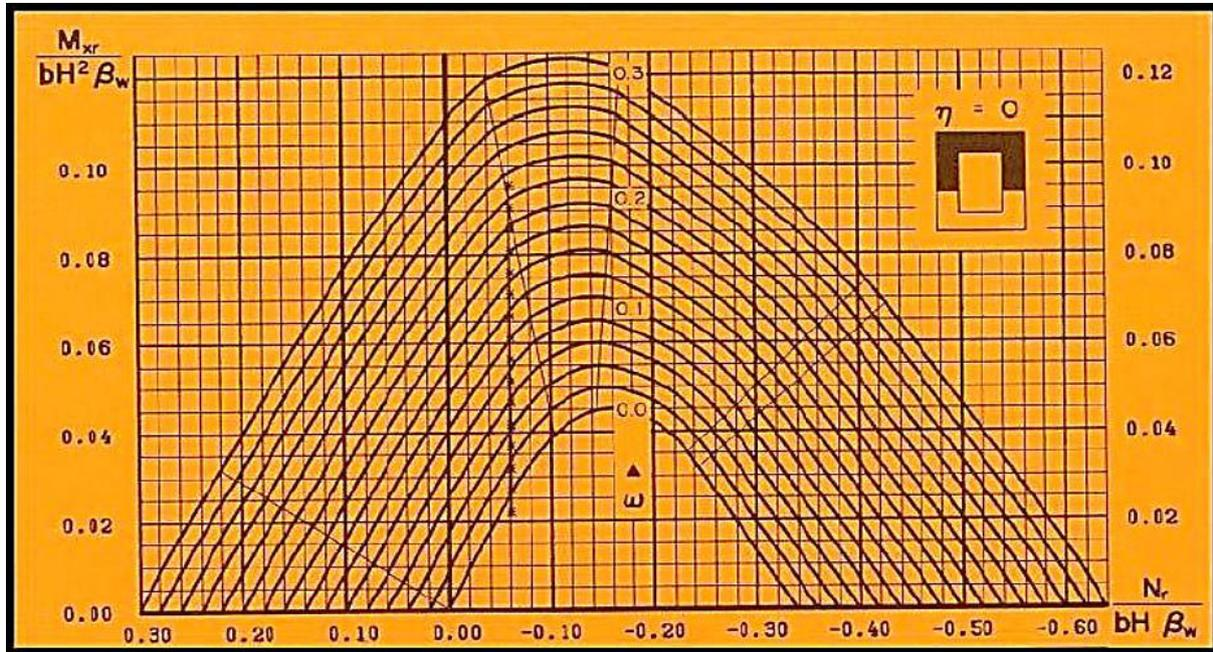
Figure IX.1 : abaque de WHALTER pour les sections creuses
