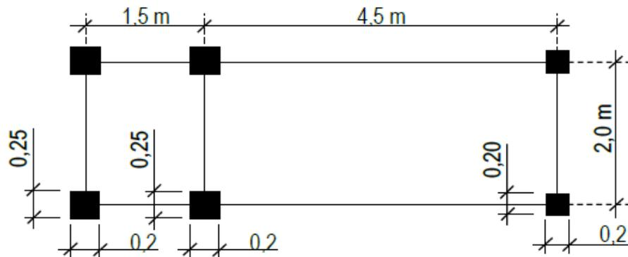
Figure III.3 : disposition du chargement Bc dans le sens transversale et vue en plan
