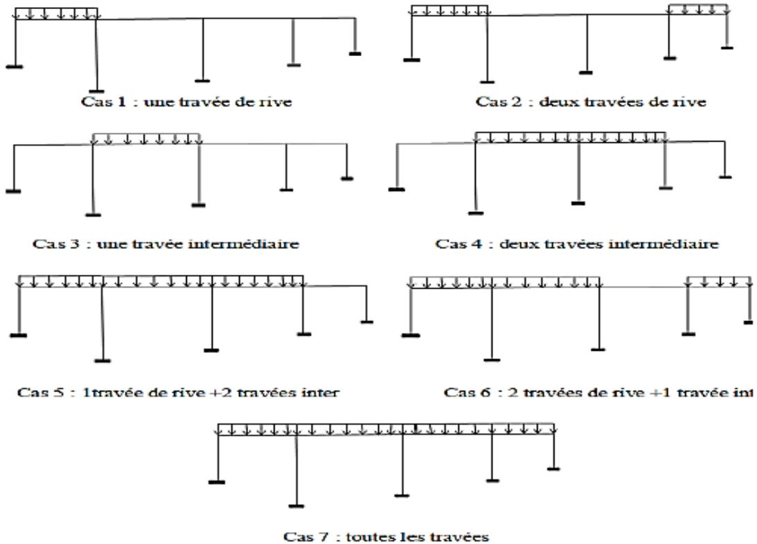
Figure III.2 : cas des chargements des travées
