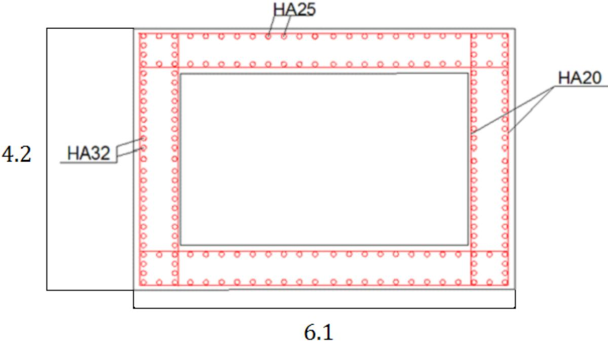
Figure IX.3 : Féraillage de la pile
