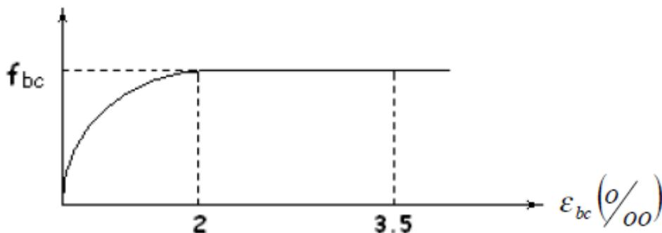
Figurel.8 : Diagramme contrainte déformation Béton à l'ELU
