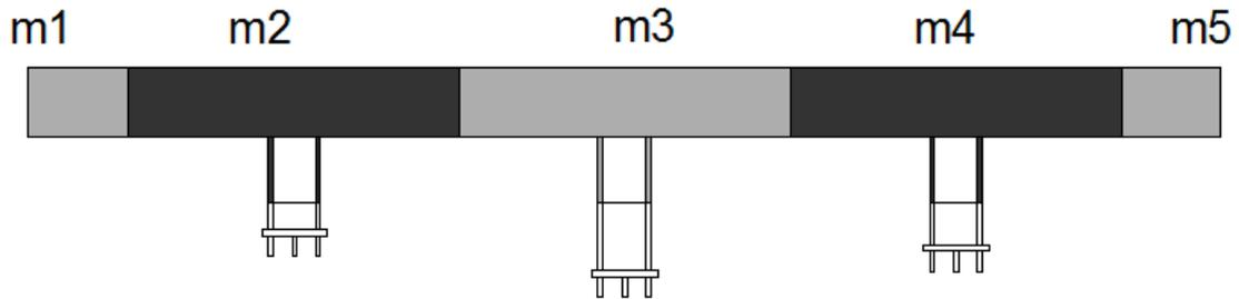
Figure XI.1 : discrétisation de la structure (points nodaux).
