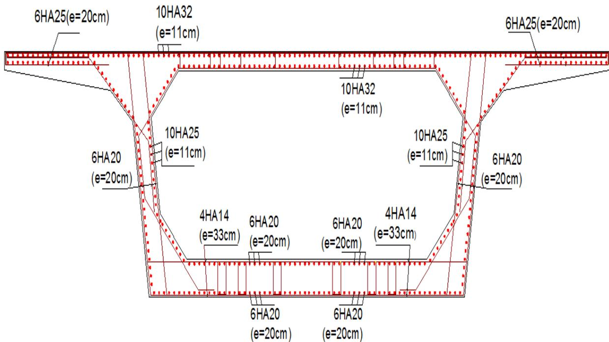
FigureVI.1 : plan de ferrailage des voussoirs sur culées et sur piles
