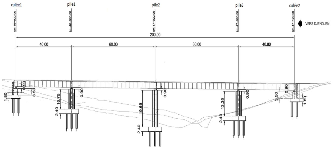
Figure I-6 : Profil en long de l'ouvrage.
