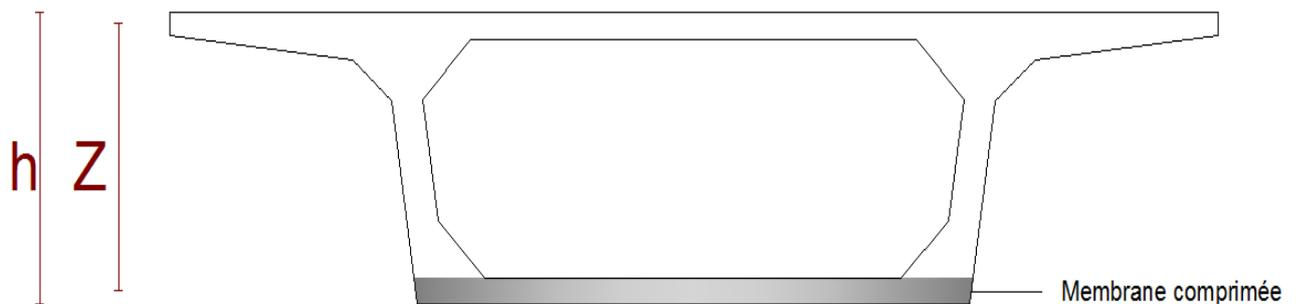
Figure VII.2 : Section comprimé due à l'effet Resal
