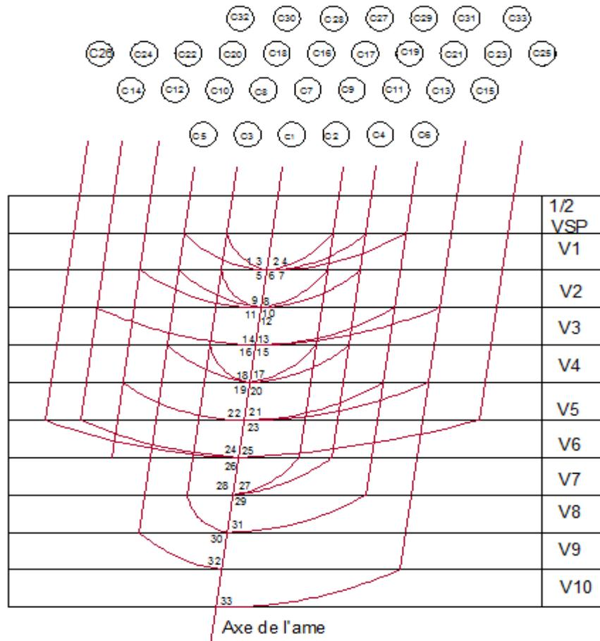
Figure V.7: Tracé en plan des câbles de fléau.
