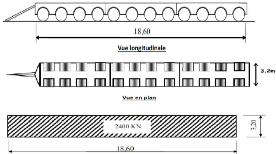
Figure –III.8.Caractéristique du convoi Type D240
