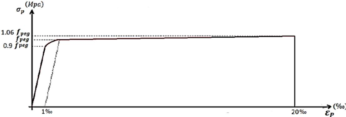
Figure I.10 : diagramme contraintes-déformations
