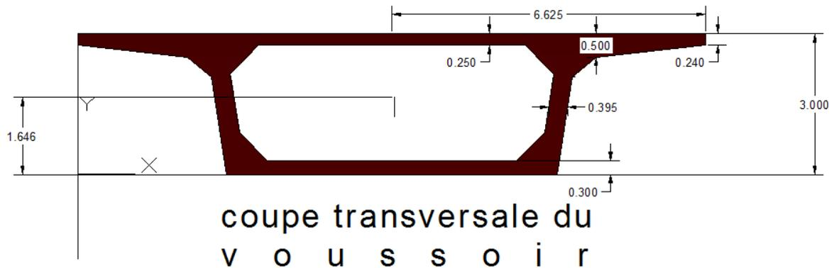
Figure II.7 : dimensions du voussoir courant (m)
