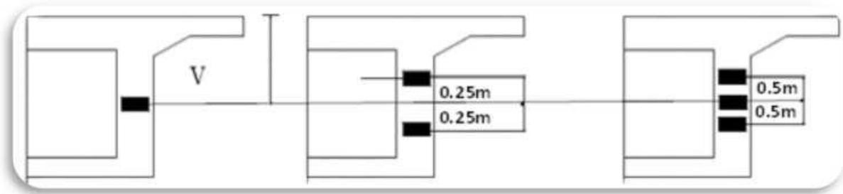
FigureV.3 : Ancrage des câbles au niveau des âmes
