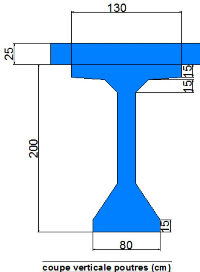
Figure II.2 : coupe transversale poutre
