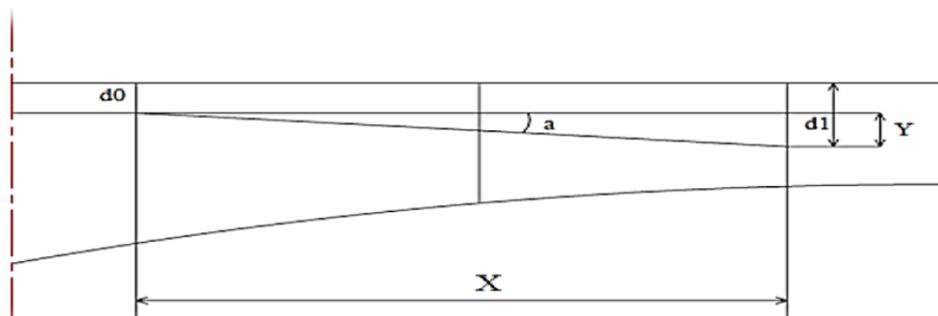
FigureV.4 : caractéristique du tracé en élévation des câbles.
