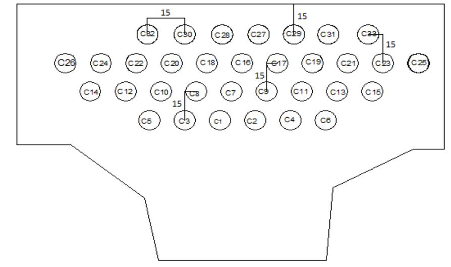
FigureV.2 : disposition des câbles dans les goussets
