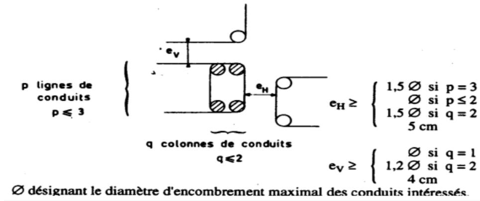
Figure V.1: Espacement entre les câbles "BPEL"
