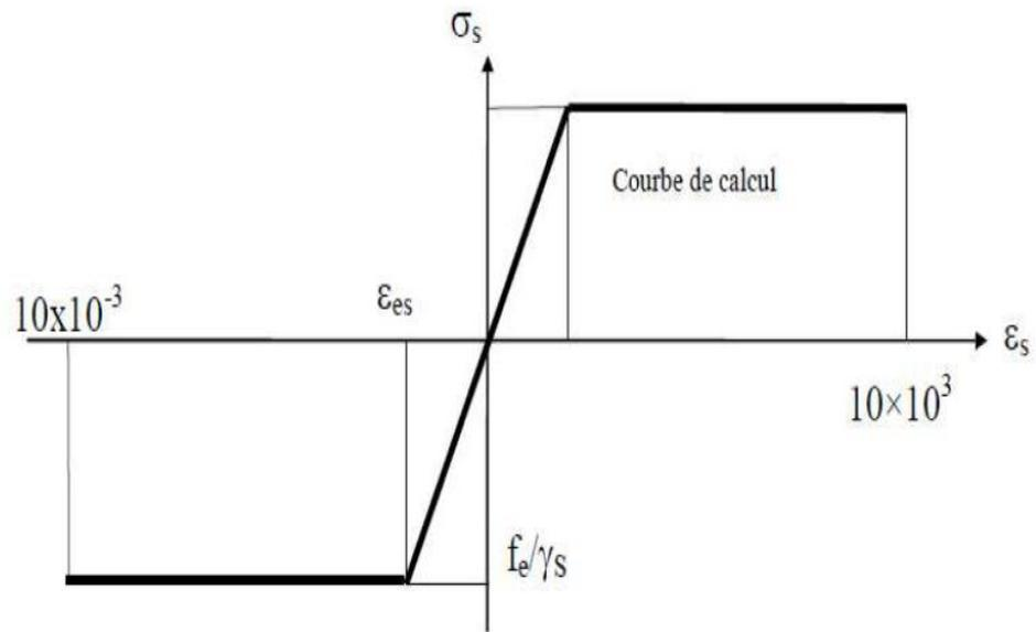
Figure I.9 : diagramme contraintes déformations de l'acier.
