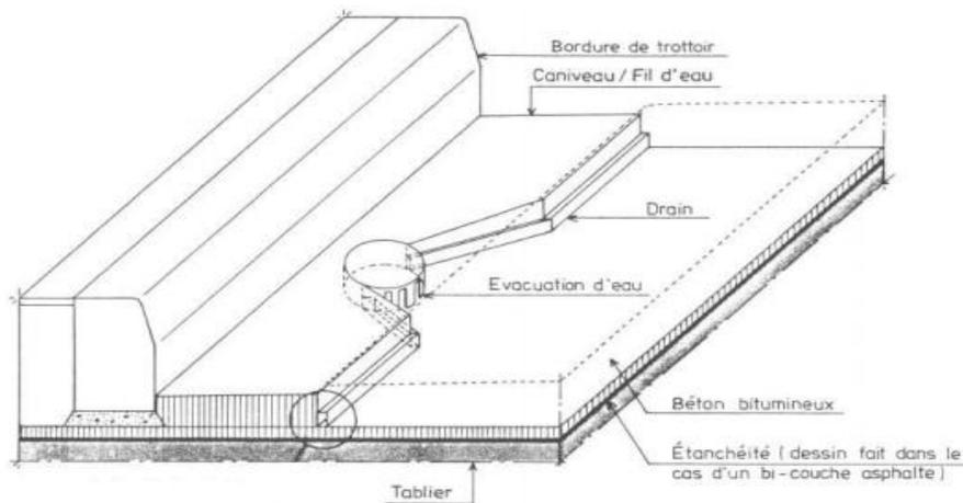
Figure VIII.7 : exemple d'un système de drainage.
