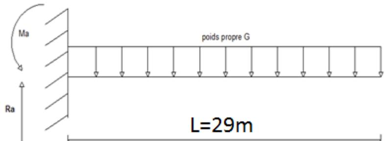
Figure IV.2 : poids propre du tablier
