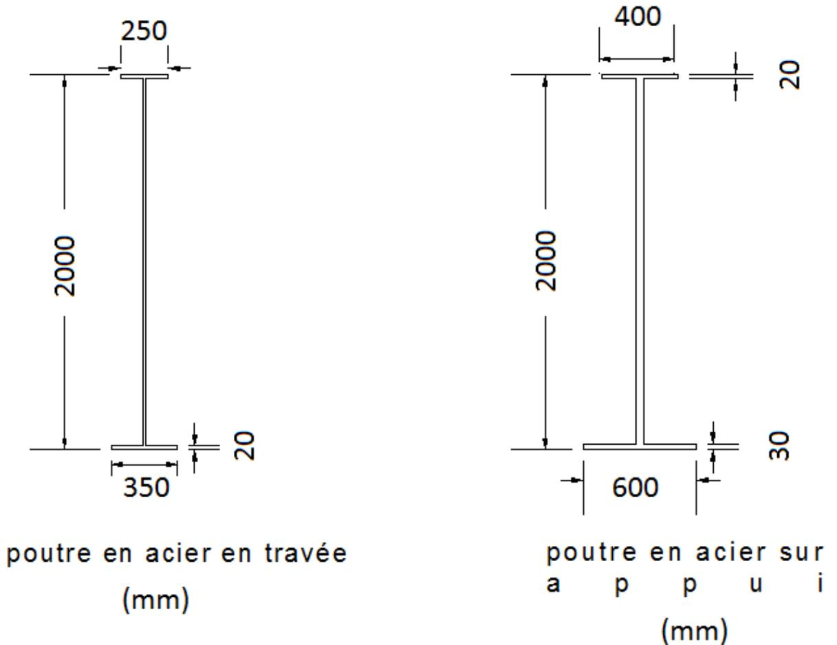
Figure II.4 : Sections transversal de la variante N°2 en (mm).
