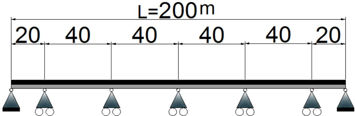
**Schéma statique d'un pont à poutre en béton précontraint**
