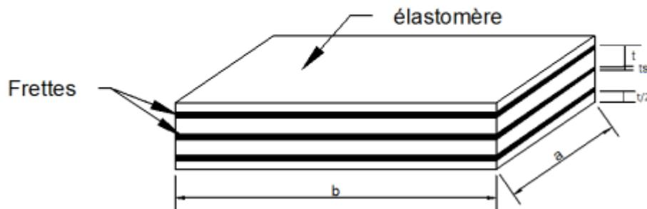
Figure VIII .1: appareils d'appuis en élastomère frettés.
