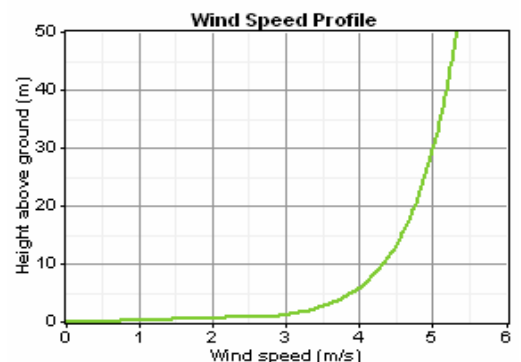
Fig- III.12: Profil de la vitesse du vent en fonction de la hauteur au dessus du sol
