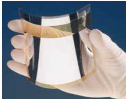
Fig- I.39: Cellule solaire plastique souple de grande dimension (100 [mm] *100 [mm]) fabriquée au Genec
