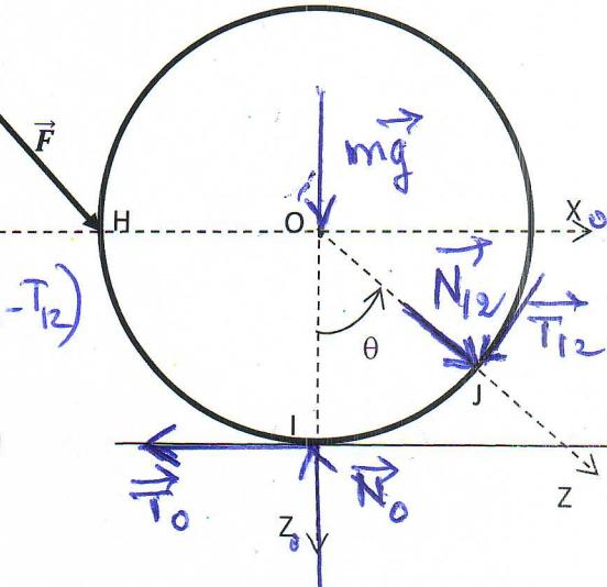
14- Montrer que lorsque  $\dot{\varphi}$  est constante et en absence de frottement en I ( $T_0=0$ ), la composante verticale de la force F est nulle ( $F_z=0$ ).
