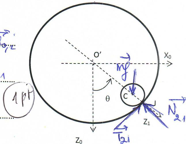
12- En déduire que la force  $T_{21}=0$  si on suppose que la vitesse angulaire du disque  $\dot{\phi}$  est constante.
