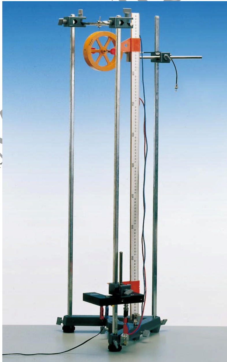
Figure 2: Montage expérimental pour la roue de Maxwell
