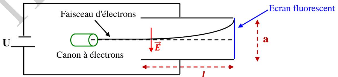
**Figure 1:** Mouvement d'un électron dans un champ électrique
