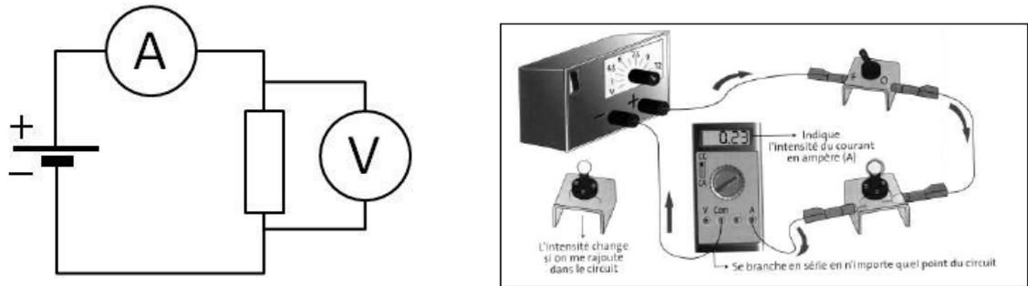
**Figure 2:** Mode de branchement de l'ampèremètre (1 et 2) et du voltmètre (1).
