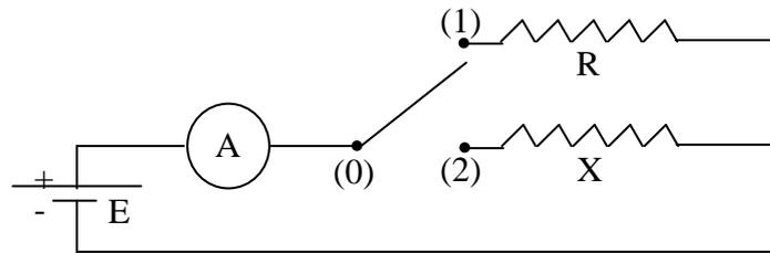
Le courant étant établi entre les deux bornes (0) et (1), l'ampèremètre mesure un courant ( $I_1 = E/R$ ) en supposant négligeable sa résistance interne. En établissant la liaison (0) et (2), on aura de même:
